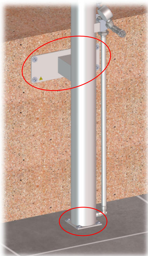
Anclaje en muro y suelo
