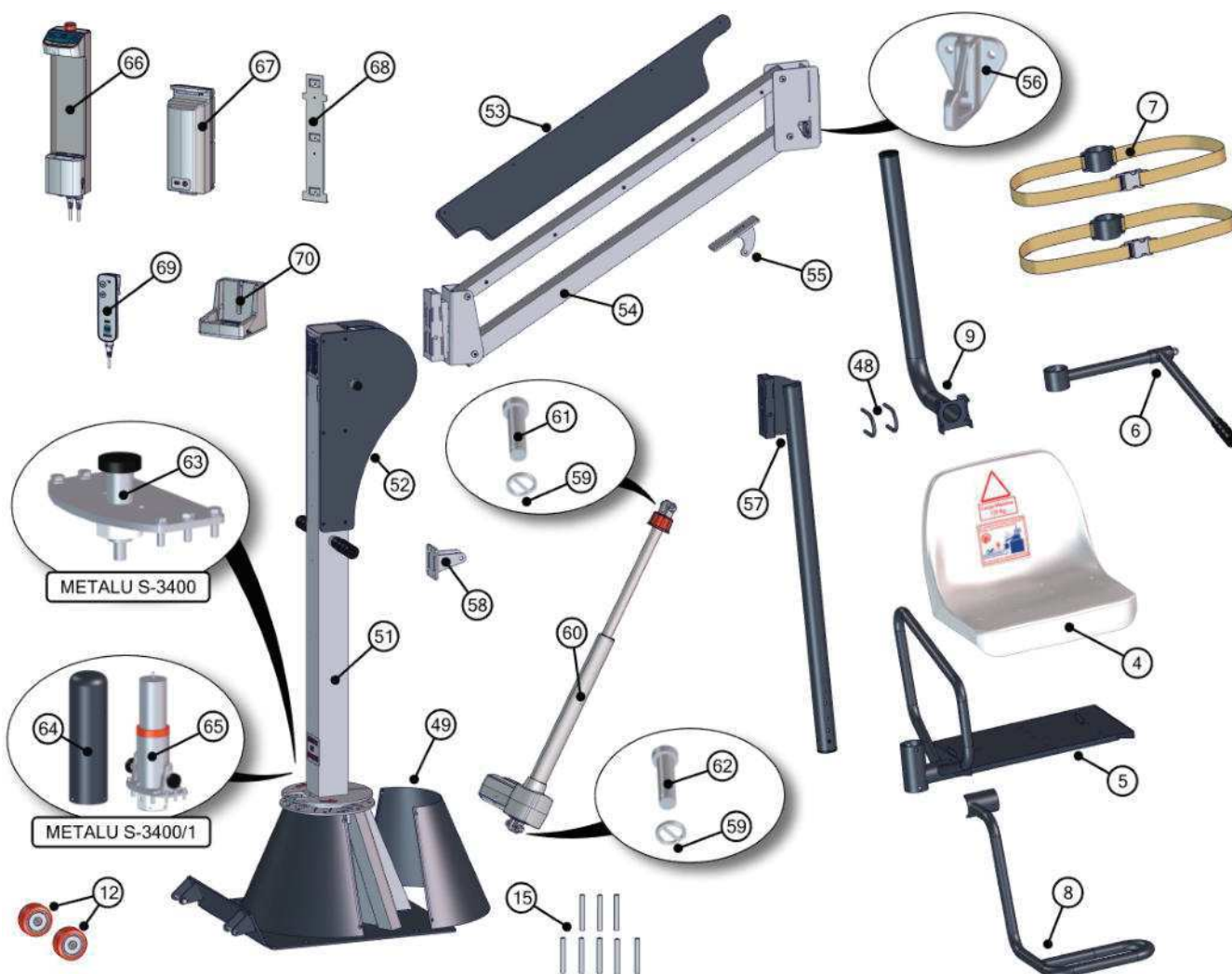
Despiece y recambios del elevador modelo METALU S-3400 y S-3400/1.
