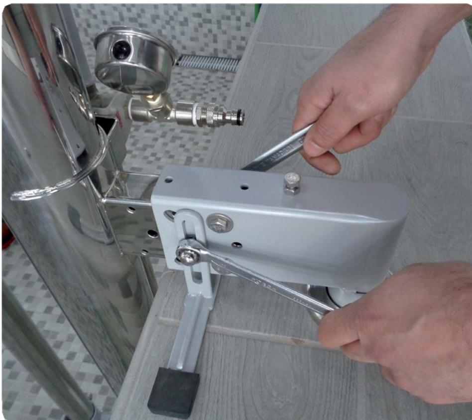
*En déplaçant les vis de nivellement (15) dans le sens de la couleur rouge, l'ascenseur bascule vers l'avant, si dans le sens de la couleur bleue, l'ascenseur bascule vers l'arrière. N'effectuez cette opération que pour corriger la verticalité de l'élévateur*
