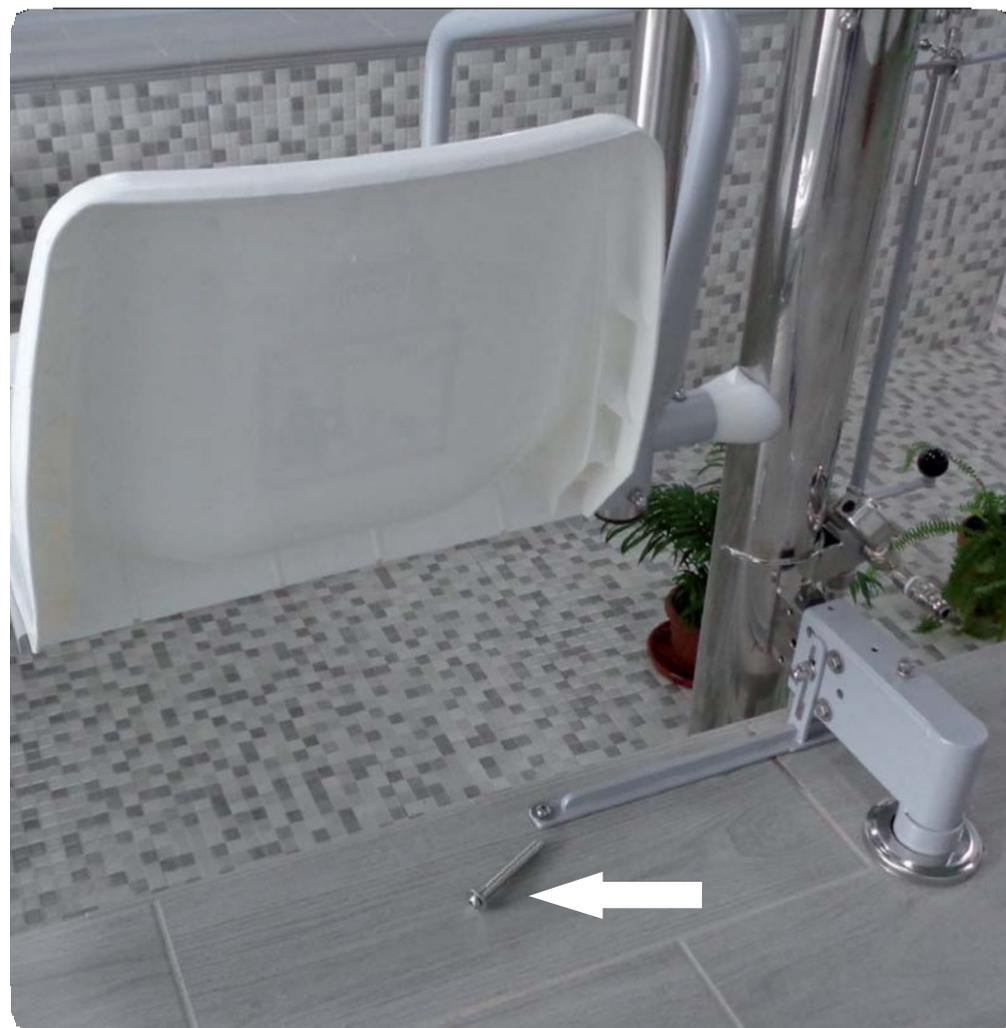
*Lorsque la pièce stabilisatrice (8) n'est pas placée sur l'élève, elle doit être placée de telle sorte que la partie la plus longue se trouve sous le siège, selon qu'elle est à droite ou à gauche.*
