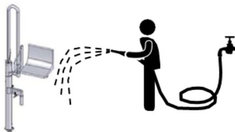
*Bien que le ISIS-PK soit fabriqué en acier inoxydable AISI 316, des éclaboussures d'eau avec du chlore, de la poussière et toutes sortes d'impuretés déposée en surface et non nettoyées, s'incrustent avec le temps dans l'acier.*
