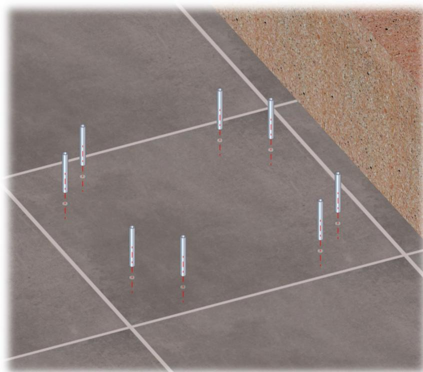
**Paso 5.** Asegurarse que no hay obstáculos en los orificio y que quedan **a ras del suelo, ni saliente ni hundido.**
