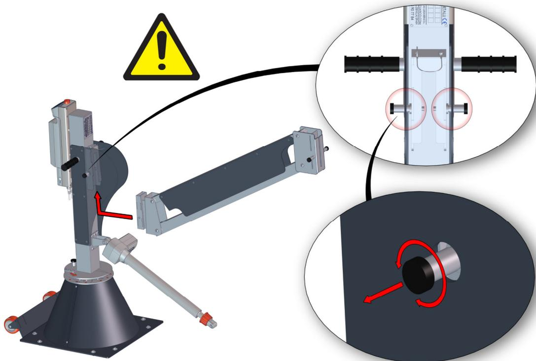
3. Fijar el actuador eléctrico a los brazos del elevador usando el pasador.
